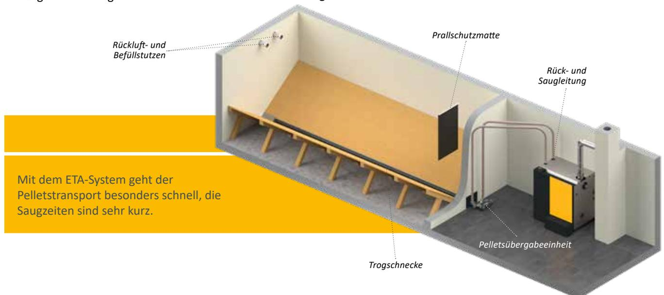
Mit dem ETA-System geht der Pelletstransport besonders schnell, die Saugzeiten sind sehr kurz.
