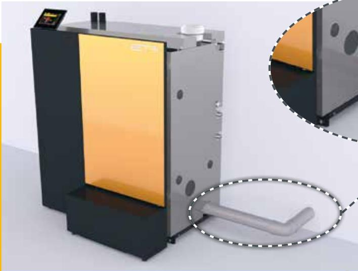
**Raumluftunabhängiger Betrieb.** Die ETA PelletsCompact kann den für die Verbrennung benötigten Sauerstoff von draußen statt aus der Umgebungsluft im Innenraum entnehmen. Der Kessel kann daher auch innerhalb der beheizten Gebäudehülle stehen, ohne dass im tiefsten Winter permanent ein Fenster geöffnet sein muss.
