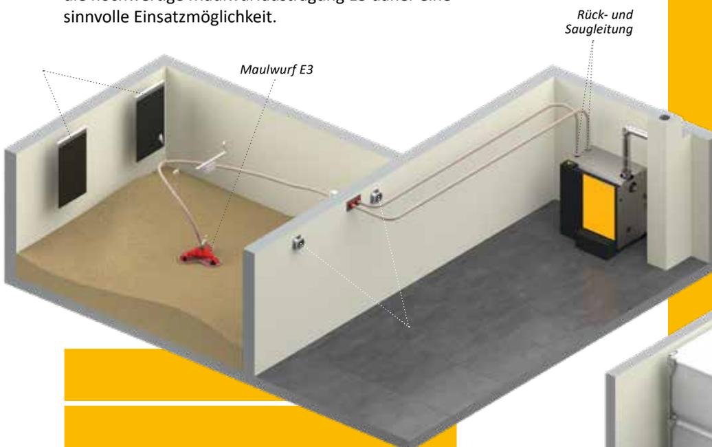
Mit der Maulwurfaustragung E3 lässt sich der Lagerraum fast vollständig entleeren und die schräge Holzkonstruktion entfällt.
