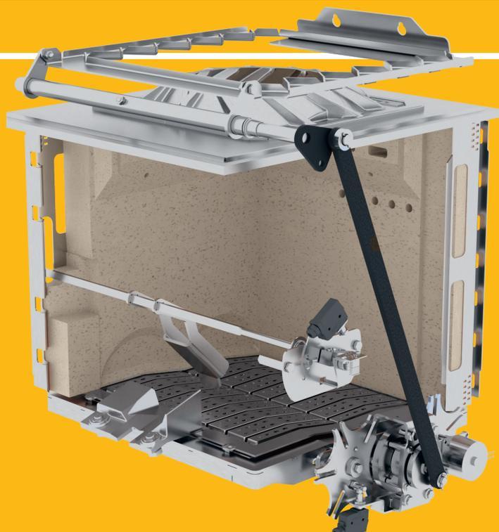
**Allumage optimisé pour économiser l'énergie.** La chambre de combustion en pierre réfractaire reste encore assez chaude après un arrêt de flamme de courte durée pour que le combustible nouvellement introduit soit enflammé par la braise résiduelle. L'allumage silencieux ne s'active qu'après des arrêts prolongés de la chaudière. Dès que la sonde lambda et le capteur de température des fumées signalent un allumage réussi, l'allumage s'éteint immédiatement. Cela permet d'économiser de l'énergie !
