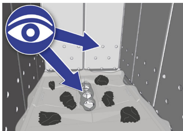
Fig. 3-3: Ouvertures d'air primaire et de combustion
