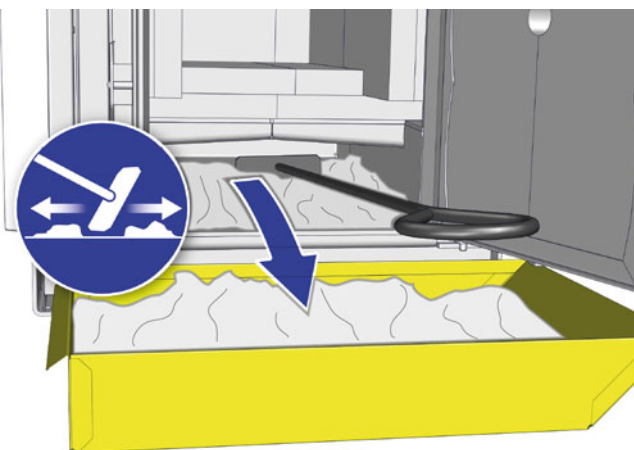
Fig. 5-40: Élimination des cendres du conduit de cendres
