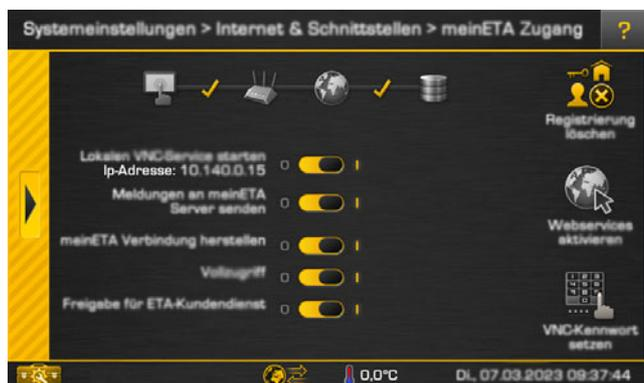
Fig. 5-35: Fenêtre de paramétrage de la télécommande
