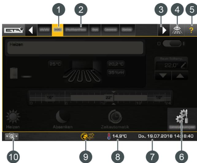
Fig. 5-1: Blocs de fonction de la régulation ETAtouch
