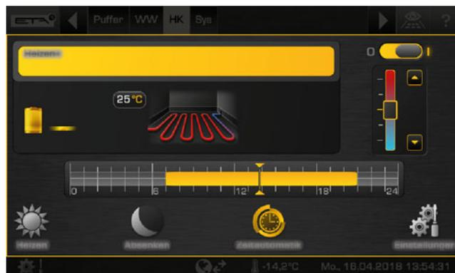
Fig. 5-89: Chauffage au sol sans sonde d'ambiance
