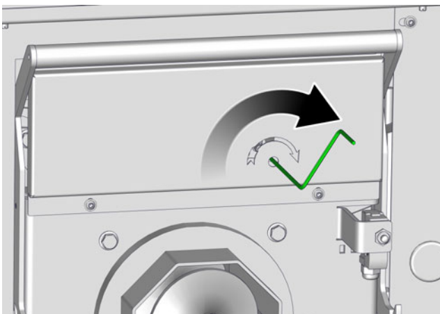
Fig. 6-8: Sens d'inclinaison correct de la chaudière avec système d'extraction de combustible à gauche
