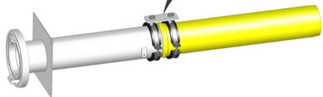
Fig. 12-15: Sécurisation de l'extension
