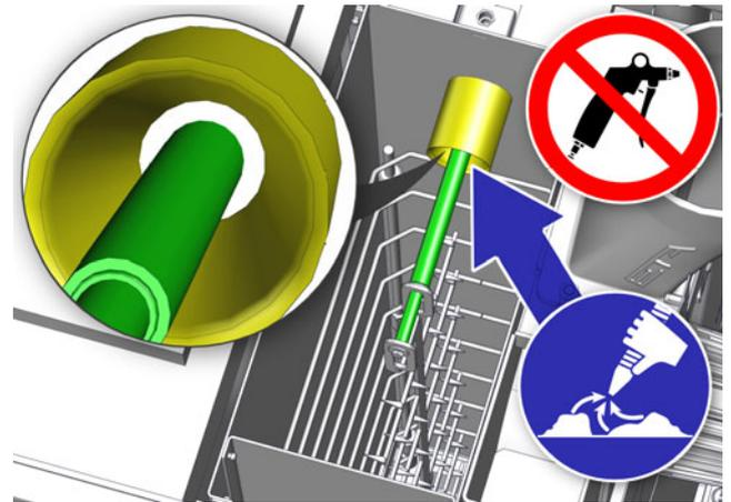
Fig. 4-48: Orifice d'air de purge sur l'isolateur
