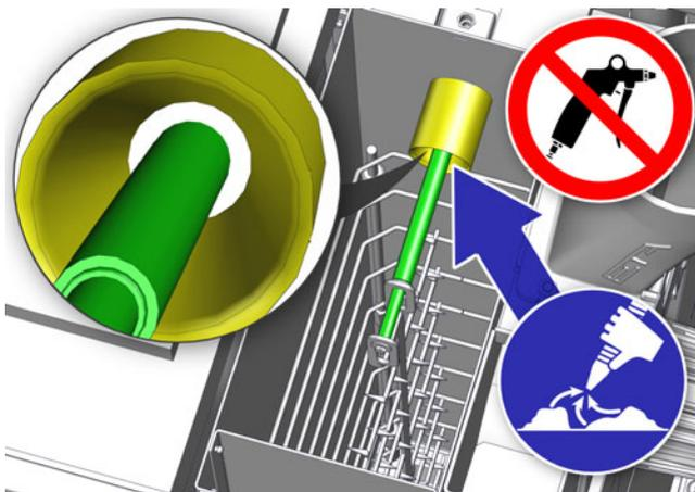
Fig. 5-45: Orifice d'air de purge sur l'isolateur
