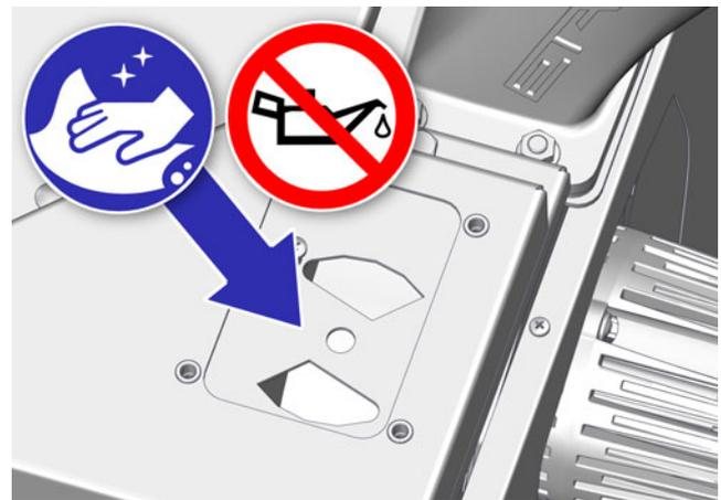
Fig. 5-33: Surface d'étanchéité
