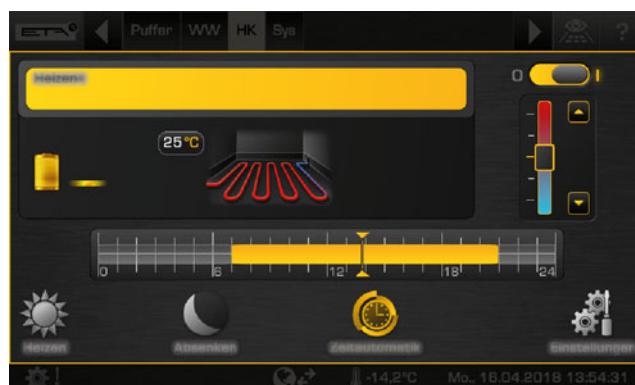
Fig. 5-89: Chauffage au sol sans sonde d'ambiance
