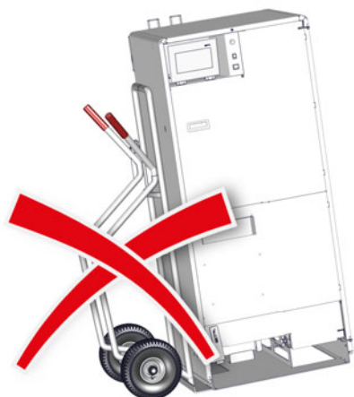
Fig. 10-7: Diable sous le réservoir
