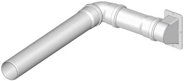
Fig. 10-25: Tuyauterie sortant sur le côté
