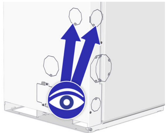
Fig. 10-22: Ouvertures pour le soufflage d'air
