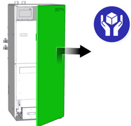
Fig. 10-3: Porte de la chaudière
