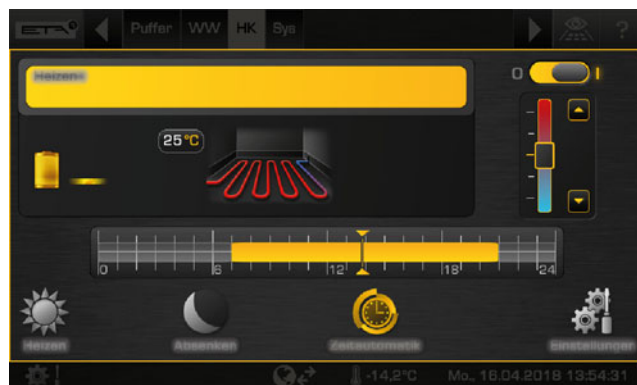
Fig. 5-89: Chauffage au sol sans sonde d'ambiance
