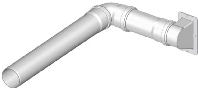
Fig. 10-25: Tuyauterie sortant sur le côté
