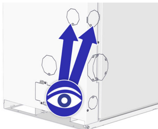
Fig. 10-22: Ouvertures pour le soufflage d'air
