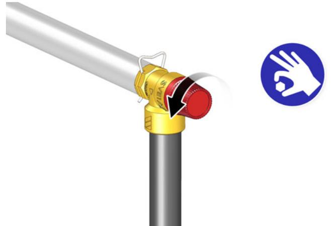
Fig. 4-14: Actionner la soupape de sécurité
