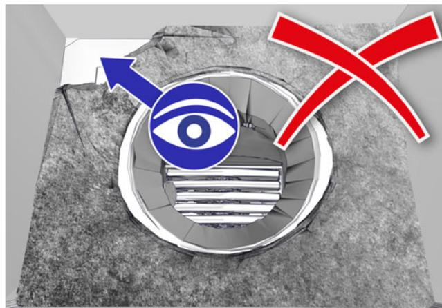
Fig. 5-31: Joint de chambre de combustion défectueux
