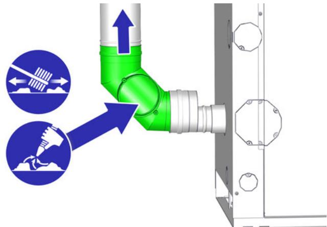
Fig. 4-34: Tube de fumées
