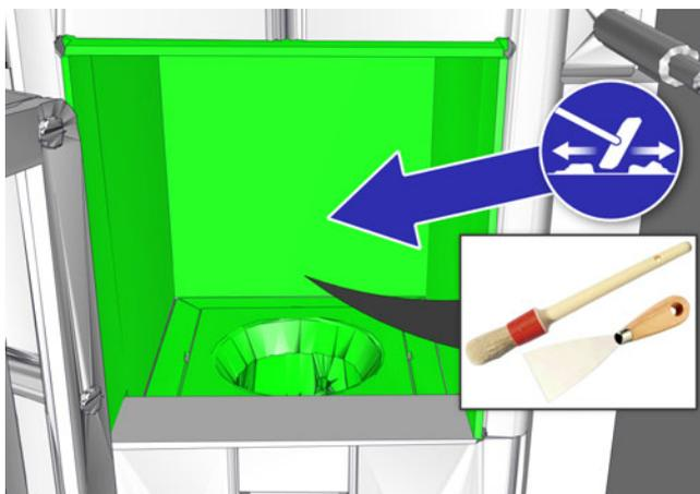
Fig. 4-28: Parois intérieures de la chambre de combustion
