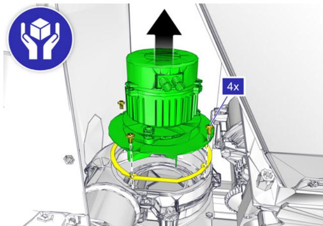
Fig. 5-43: Ventilateur d'extraction des gaz de combustion
