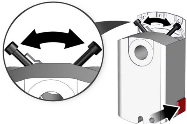
Fig. 5-69: Actionner manuellement le servomoteur
