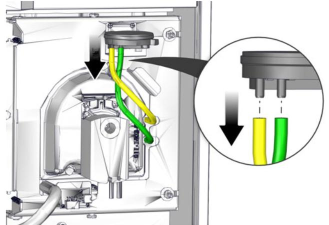
Fig. 5-66: Tubes en silicone
