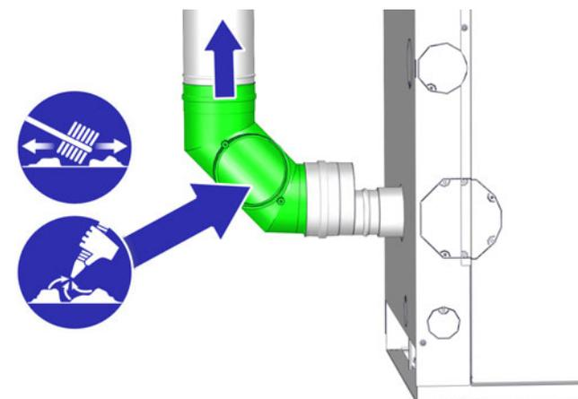
Fig. 5-39: Tube de fumées
