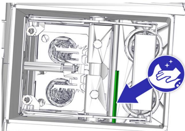
Fig. 5-22: Sonde de température des gaz de fumée
