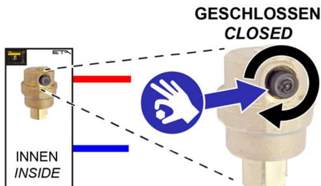
Fig. 4-8: Purgeur automatique à l'intérieur de la chaudière
