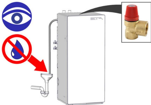
Fig. 4-15: Soupape de sécurité de la chaudière
