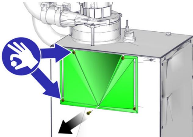
Fig. 5-48: Vis sur le couvercle de maintenance
