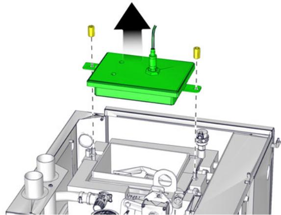
Fig. 5-20: Couvercle de l'échangeur de chaleur
