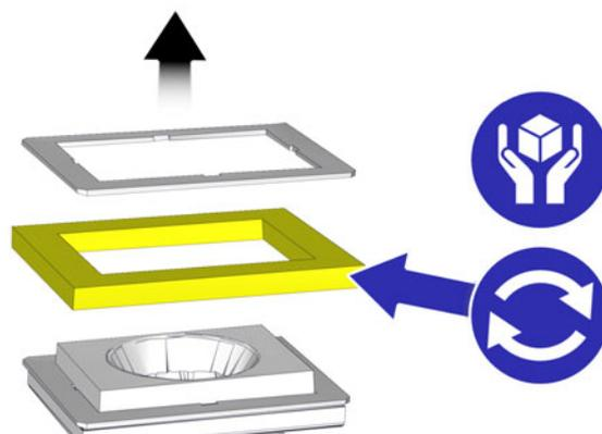
Fig. 5-32: Joint de chambre de combustion
