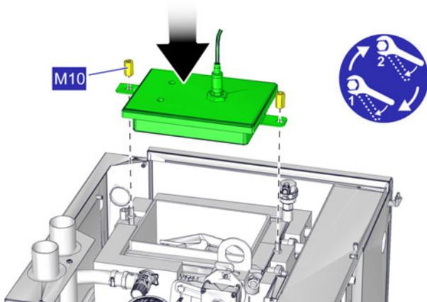
Fig. 5-26: Couvercle de l'échangeur de chaleur
