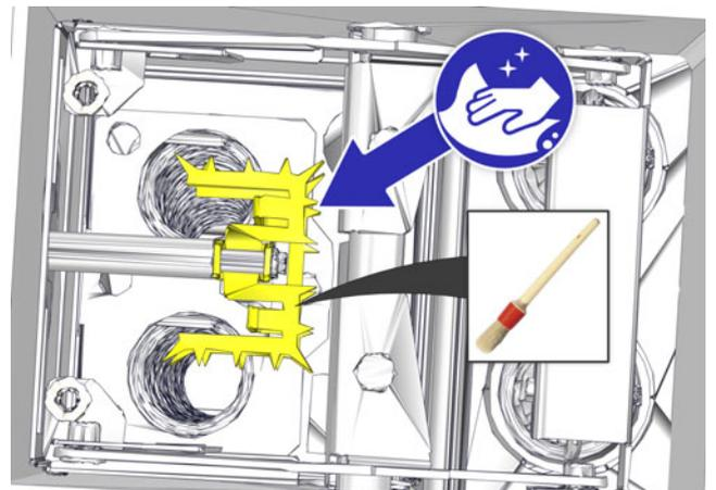
Fig. 4-22: Électrode de pulvérisation
