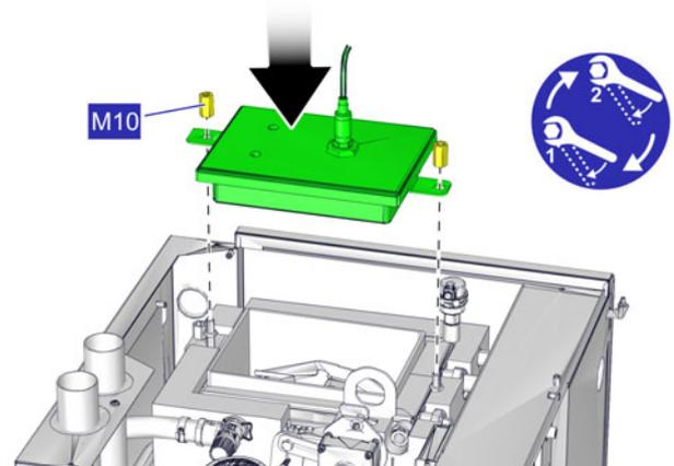
Fig. 4-25: Couvercle de l'échangeur de chaleur
