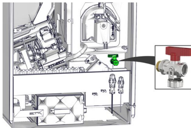
Fig. 4-11: Raccord de remplissage et de vidange
