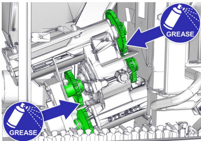
Fig. 5-60: Roues dentées
