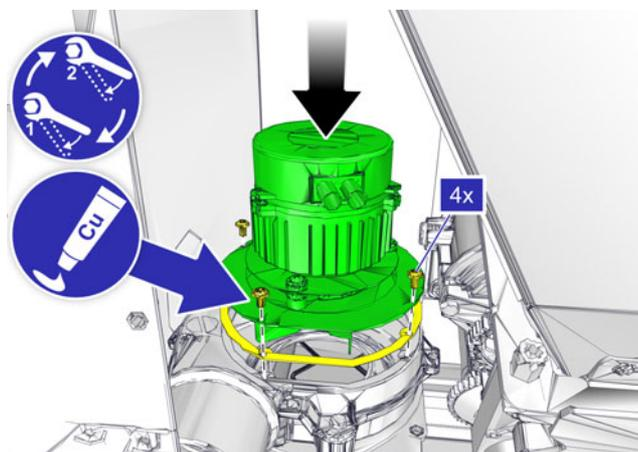
Fig. 5-47: Ventilateur d'extraction des gaz de combustion
