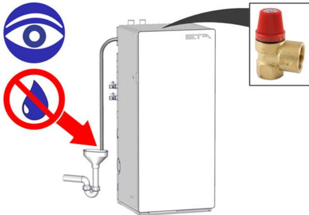
Fig. 5-15: Soupape de sécurité de la chaudière
