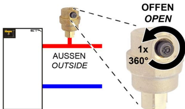
Fig. 5-7: Purgeur automatique hors de la chaudière
