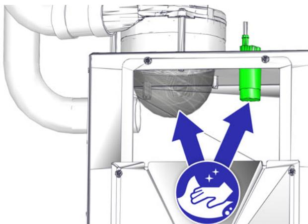
Fig. 5-50: Tamis et capteur de niveau de remplissage
