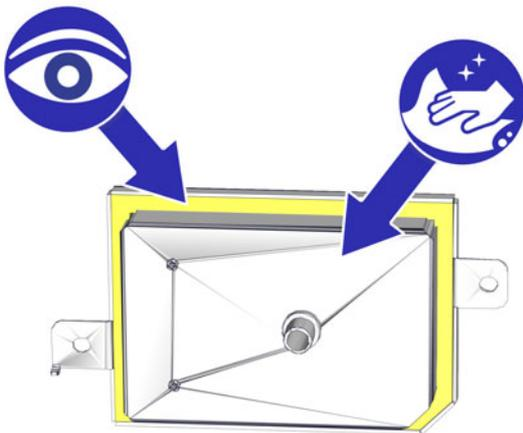
Fig. 4-24: Couvercle de l'échangeur de chaleur
