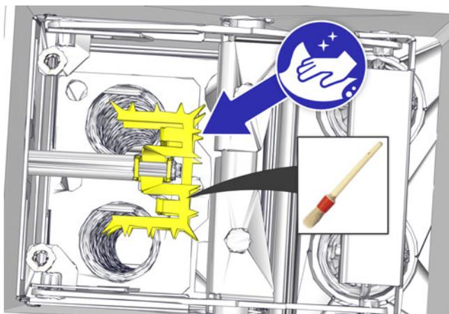
Fig. 5-23: Électrode de pulvérisation
