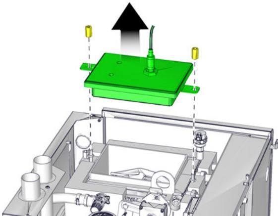
Fig. 4-19: Couvercle de l'échangeur de chaleur
