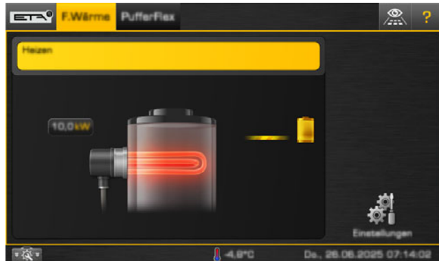
Fig. 5-112: <p>Représentation sous forme de barre chauffante photovoltaïque
