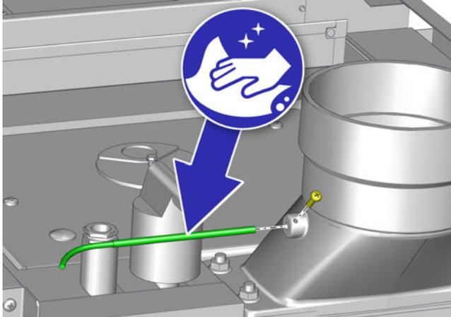
Fig. 5-39: Capteur de température des gaz de fumée
