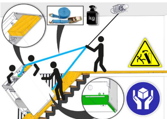
Fig. 9-6: Transport avec palan
