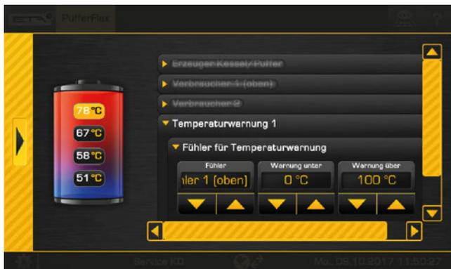
Fig. 6-81: Réglages des avertissements de température
