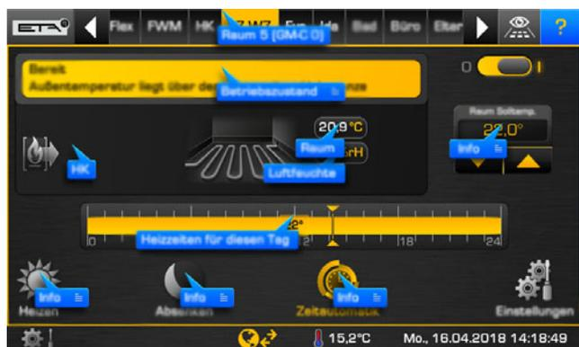
Fig. 6-6: Aide active dans l'interface utilisateur
