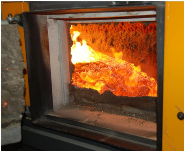
Fig. 4-7: Contrôle du lit de braises
