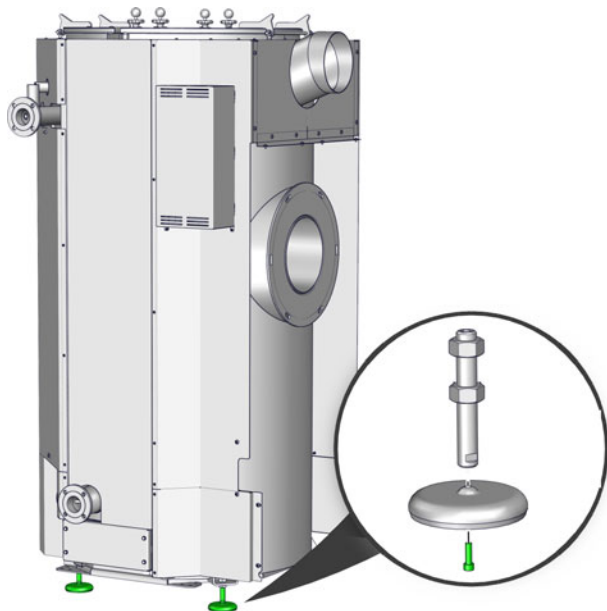
Fig. 9-1: Montage des pieds articulés
