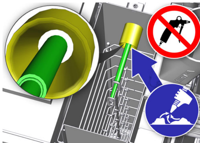
Fig. 4-47: Orifice d'air de purge sur l'isolateur
